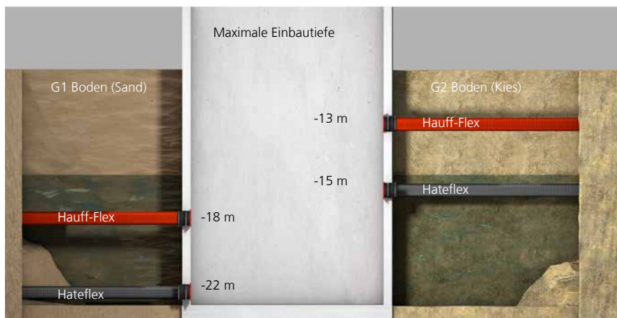
Maximale Verlegetiefe von Kabelschutzschläuchen
